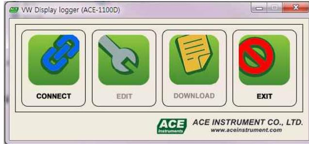
진동현 센서 디스플레이 로거의 접속을 위해서는 RS-232 Cable이 연결되어 있는 상태에서 [Connect] 버튼을 클릭하면 아래와 같은 팝업창이 생성되며 Communication Port를 지정한 후 Connect하여야 합니다. (Auto를 클릭하면 자동으로 Com. Port를 찾아서 연결합니다.)
