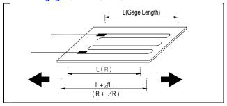
게이지의 길이 변화율( $\triangle$ L/L), 곧 Strain( $\epsilon$ )과 저항변화율( $\triangle$ R/R)은 비례합니다.
